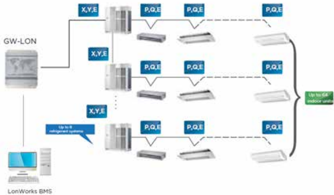
نحوه اتصال تجهیزات تحت پروتکل LonWorks
